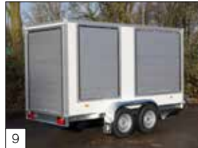
Option : volet roulant en aluminium à l'arrière et volets coulissants sur les côtés.
