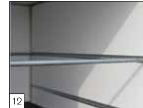
Option : système d'arrimage de la charge dans la structure fermée avec barre télescopique et sangle d'arrimage.
