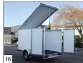
Option : couvercle pivotant à l'avant (option possible jusqu'aux dimensions maximales 300 x 150 x 180 cm).
