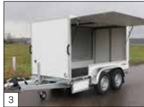
Option : hayon de vente latéral et petit hayon devant le garde-boue, pivotant vers le bas.
