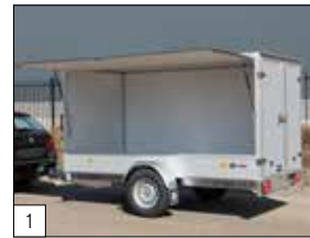
Option : hayon de vente latéral qui peut être monté aussi bien à gauche qu'à droite (dans le sens de la marche).
