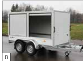
Option : 2 volets coulissants en aluminium (largeur maximale 150 cm) dans la paroi latérale, avec montant central.
