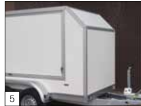
Option : partie avant inclinée (angle égal d'environ 40 x 40 cm).
